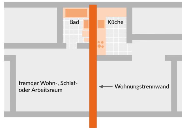
Bild 6.3: Ungünstige Diagonalposition eines lauten Raumes zu einem schutzbedürftigen, leisen Raum an einer Wohnungstrennwand
