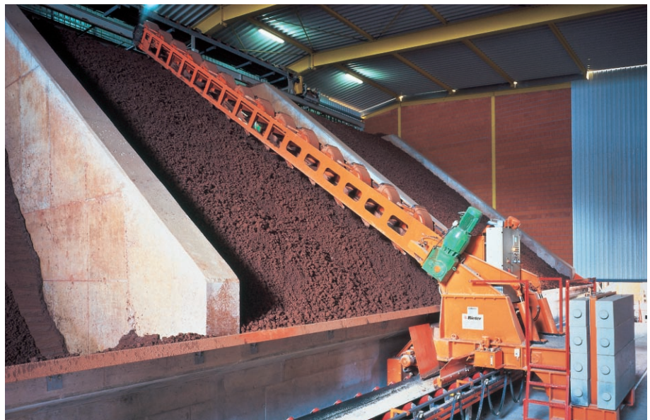
Bild 26 Homogenisierung des Tons im Sumpfhaus.
